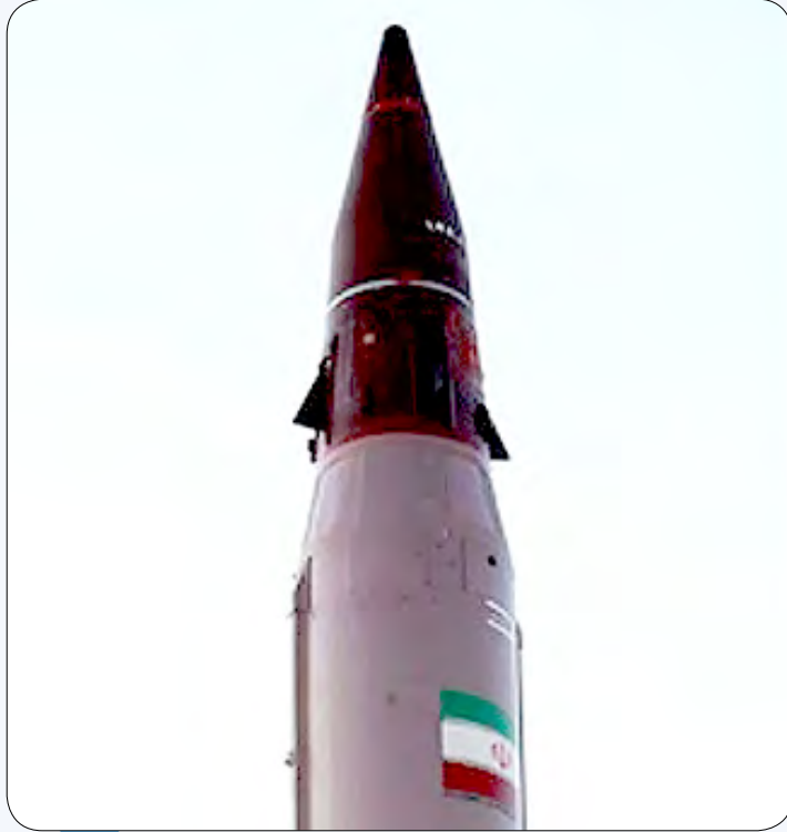
زعانف التحكم في مركبة إعادة الدخول المناورة للصاروخ عماد
